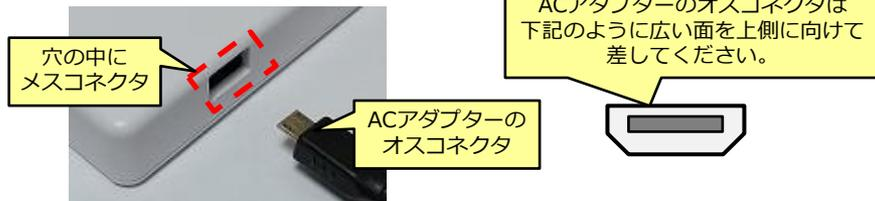
ACアダプターのコンセント差込部分をコンセントに差すと、IoTゲートウェイ機器が起動し、小型画面に「FanBright Co Ltd All Right Reserved.」と表示されます。
